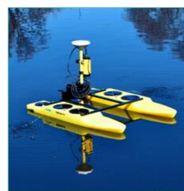
Fig. 2 Ecosonda Valeport Midas Surveyor
